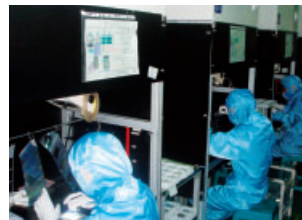
クリーンルームにおける液晶用バックライト組立作業
